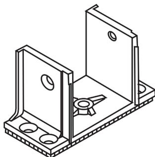
соединитель импоста с уплотнительной пластиной
