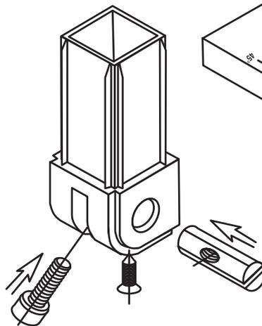
соединитель с изменяемым углом в наборе
